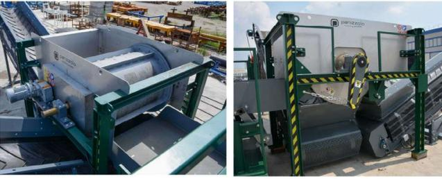
Constitué d'une structure qui contient le tambour magnétique avec des panneaux de protection et un carter de broyeur. Cela permet d'extraire les matériaux ferreux du flux de matériaux généralement véhiculés par une table vibrante.
