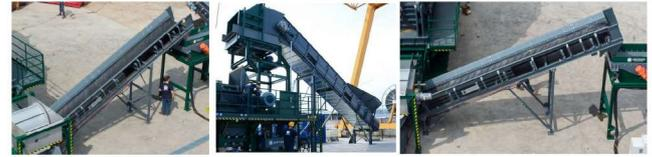
Convoyeur conçu pour transporter des déchets métalliques en tôle ondulée et peinte époxy:
