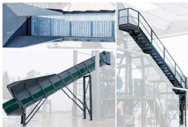
Il achemine le matériau à traiter à l'intérieur du moulin, maximisant ainsi le rendement de la production.
